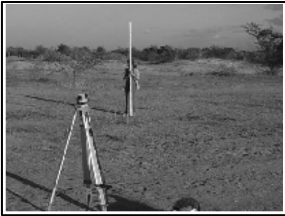
FOTO 05 – PERFILAGEM TOPOGRÁFICA REALIZADA NO LEITO DO RIO JAGUARIBE (JAN/2004)
