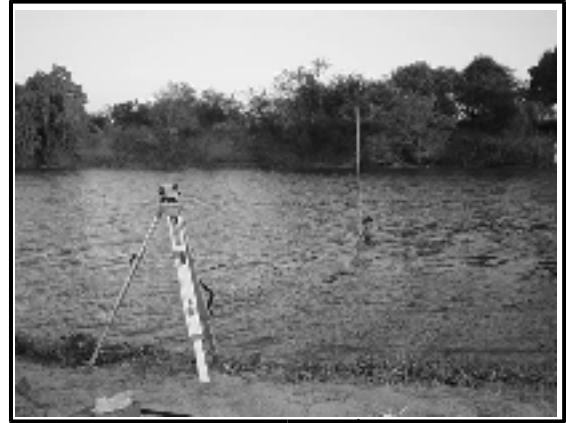
FOTO 06 – PERFILAGEM TOPOGRÁFICA REALIZADA NO LEITO DO RIO QUIXERÉ (JAN/2004)
